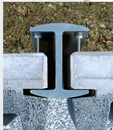
Querschnitt Pfosten in mm
